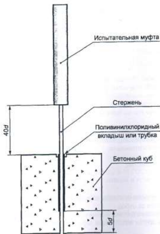
Рисунок Д.1 — Схема установки АКП в бетон куба
