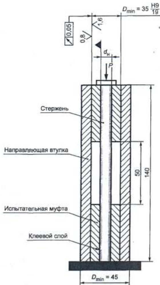
Рисунок В.2 — Приспособление для испытания образцов на сжатие
